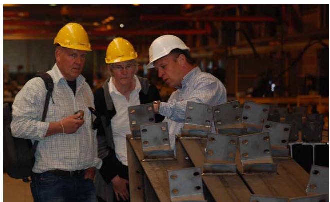
Det asymmetriske åsebeslag er ligesom den øvrige ramme-konstruktion produceret ved hjælp af elektroniske programmeringer. Beslagene til stålåsene påsvejses asymmetrisk for at tilgodesse den specielle bygningsgeometri.
