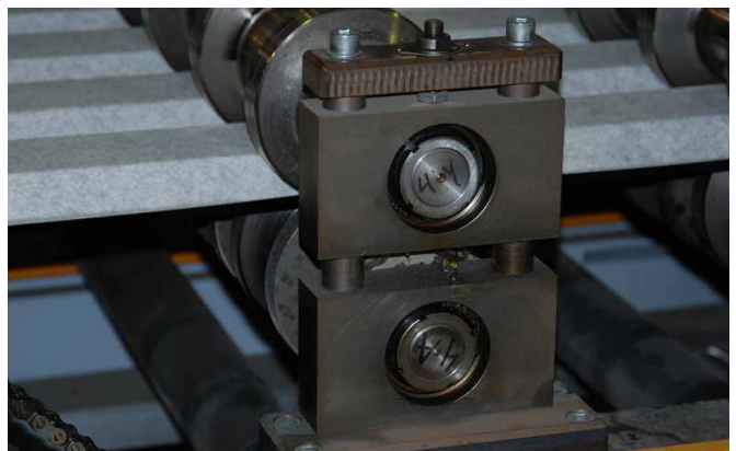
Profilering af den plane stålplade påbegyndes. Der påføres et porøst materiale på undersiden for at minimere kondensdrøp.
