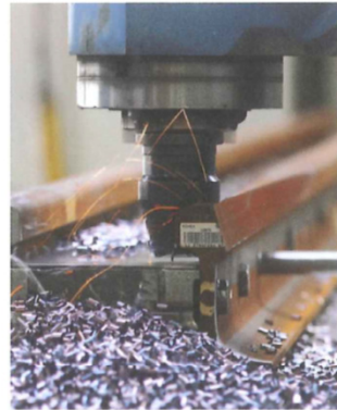
Bewerken van een spoorstaaf tot compensatielas.
