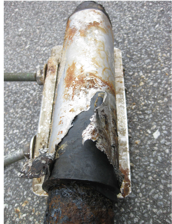
AISI 316 stål efter mindre end 10 år
