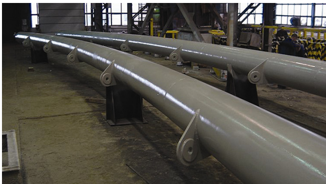
Figur 8. De to færdige buesektioner klar til afrejse til Danmark. Øjerne til trækstag er alle påsvejst med forskellig vinkel til buen. Foto Bladt.
